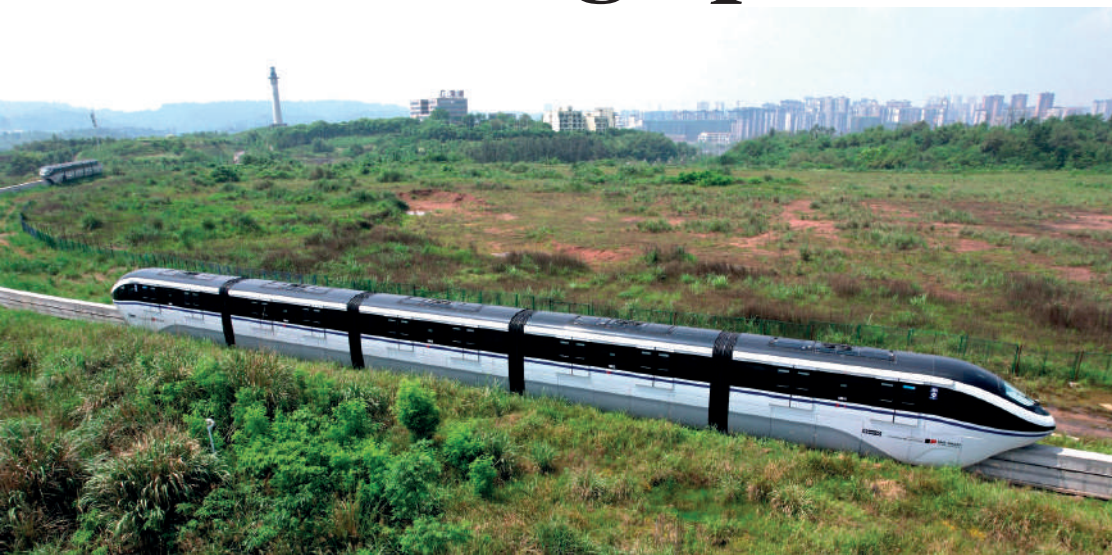
Cada composição do monotrilho é formada por cinco carros, sendo que os de extremidade contam com 21 assentos cada, os intermediários com 24 assentos, totalizando 114 lugares
